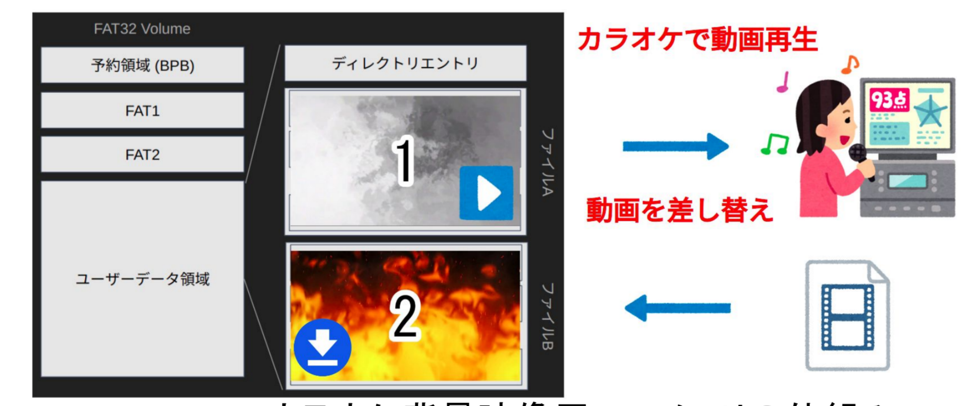
Figure 3. カラオケ背景映像用USBメモリの仕組み ファイルA,Bがあり、一方のファイルを再生中に、もう一方を次の予約に応じた曲の動画へ差し替える
